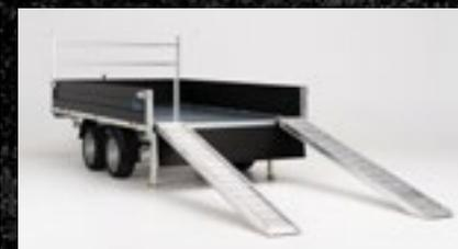
■ Aluminium Auffahrschienen und Stützen
